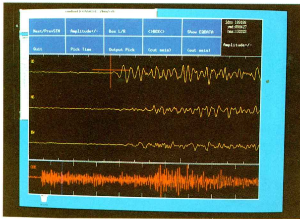
図1-(c) 十字カーソルによって走時の読み取りを行うことができる。 Fig. 1-(c) We can pick up travel times by the large cross cursor.
