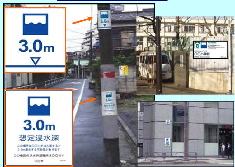
電柱や公共施設に、想定浸水深や避難所の情報等を表示 ※現在、東京都北区(荒川)、兵庫県豊岡市(円山川)に設置
