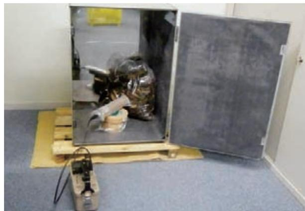
遮蔽した状況での線量率測定
