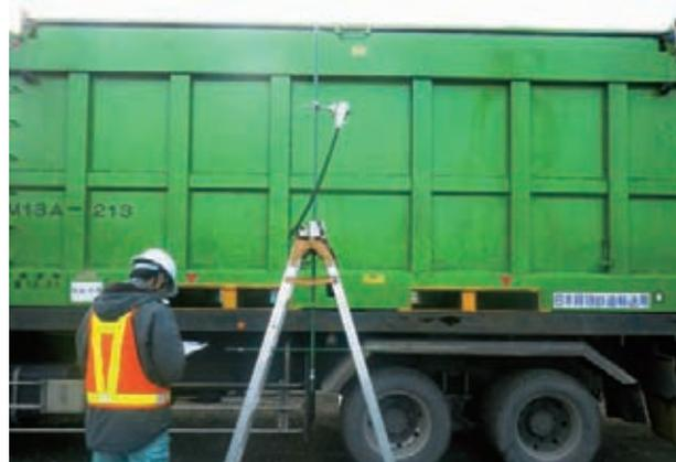
災害廃棄物を搬送するコンテナの空間線量率測定
