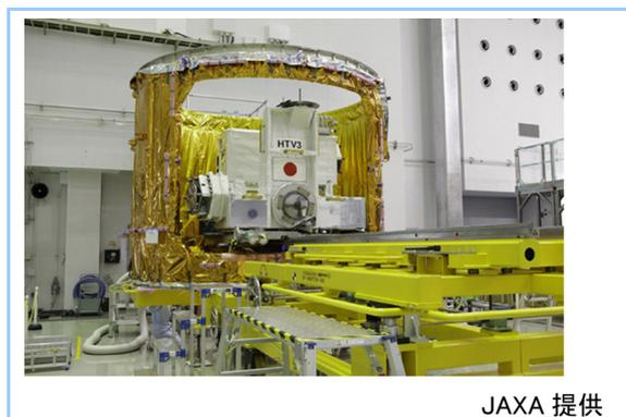
図9 非与圧部に船外物資を搭載した曝露パレットを挿入した状況
