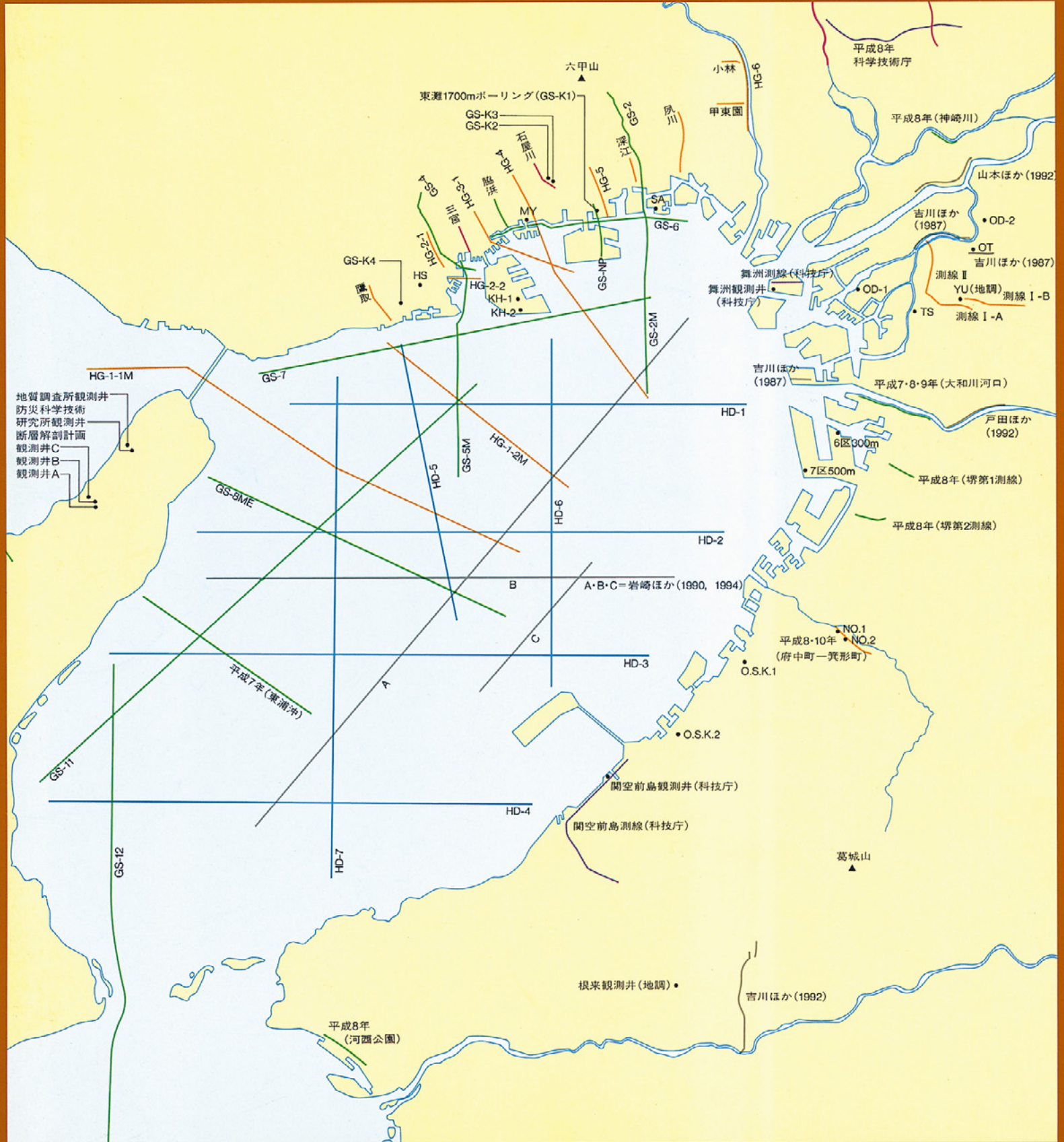
大阪湾とその周辺地域の反射法地震探査測線と主なボーリング地点(本文 図2-1の部分)
