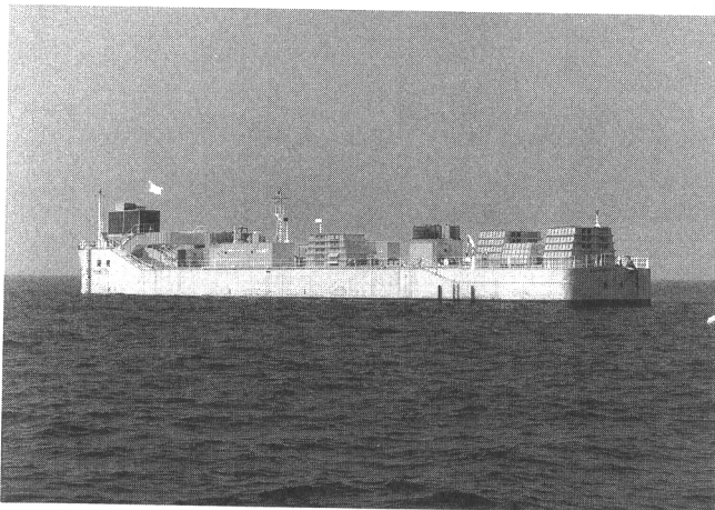
写真—9 第II期における海上実験中の浮体式大型波力発電装置「海明」
