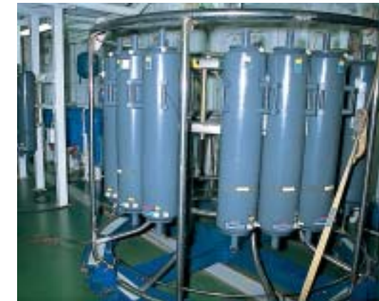
採取した海水の成分分析などをいかに早くおこなうか、という観点から開発されたのがこのロゼッタ式海水採水器。大きな1本の容器内に30リットルの海水が入る(左)
