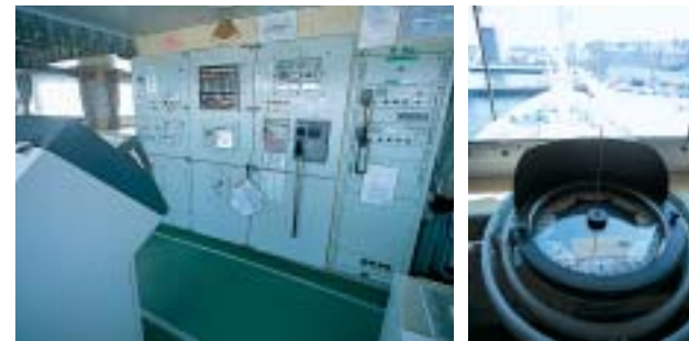
前部操舵室には減揺装置の制御機器のほか、音響航法装置(送受信器昇降装置付)、電波航法装置などの計器類が並ぶ。実験設備では低温・X線実験室、クリーンルーム、ウエット・ドライルームなどの研究室が13室と充実している
