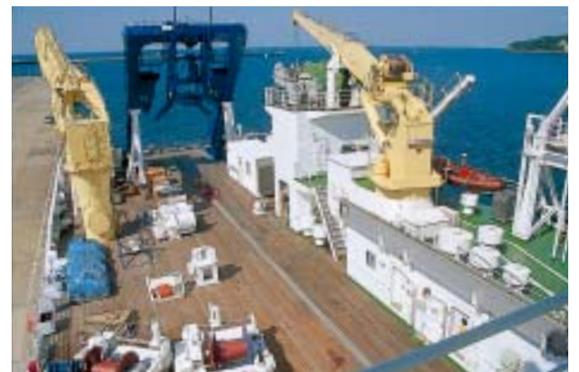
船尾には多関節式デッキクレーン・ジブ式デッキクレーン・係留ブイハンドリングシステム・ロゼッタ採水器ハンドリングシステムといった海洋観測を支援する機器が整然と配置されている(下)
