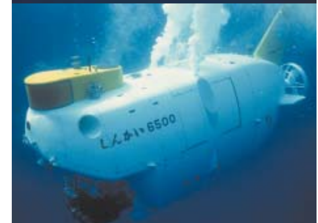
「しんかい2000」は1981年に完成した日本初の本格的な有人潜水調査船で、水深2,000mまで潜ることができる（写真上）。1989年の完成以来、世界最先端の水深6,500m級潜水調査船として数々の業績を残してきたのが「しんかい6500」。これまでの650回を超える潜航で、高い安全性が実証されている
