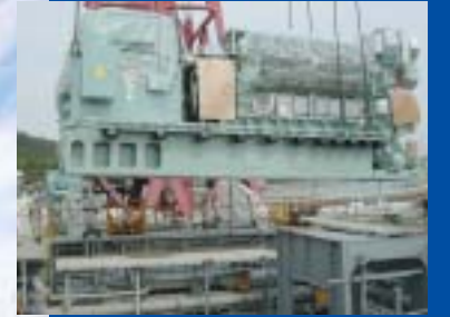
「ちきゅう」の心臓部である巨大な主発電機。この主発電機6機に補助発電機2機が搭載される
