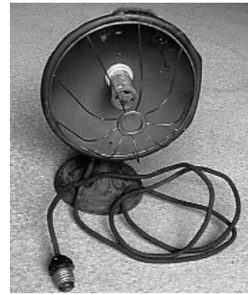
昭和3年製小型反射ストープと付属の回転アタチンプラグ
