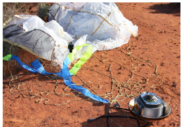
図-6 発見されたカプセル(ヒートシールドは分離されている)
