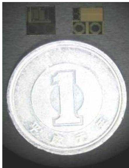
図 5.3 試作チップの顕微鏡写真（上右：メディアチップ、上左：リーダーチップ）
