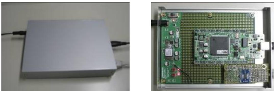
図 5.6. FPGA ボードユニットの外観 (左) と内部 (右)
