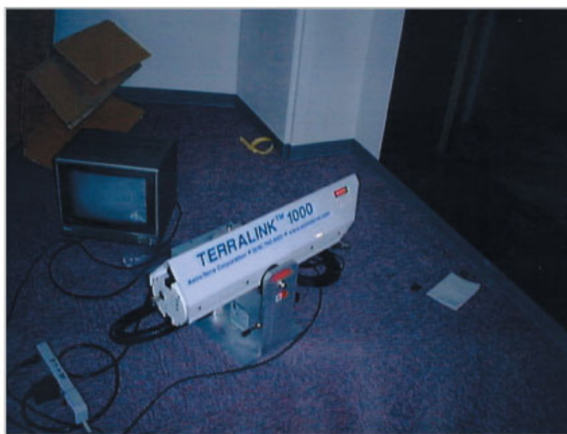
図8 稚内商工高校向けレーザー光空間通信装置(稚内北星)
