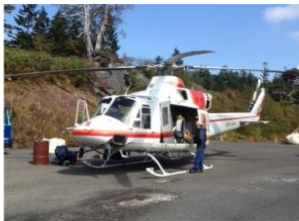
<工事資材の運搬用ヘリコプター（八幡平）>
