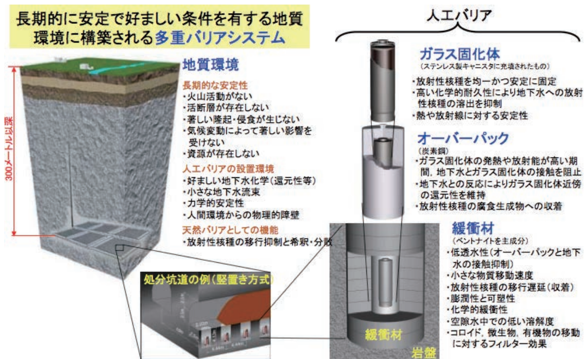
図3 地層処分システムの構成要素と期待される安全機能
