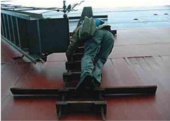
写真6-2-6 舷側が高いのでアコモデーションラダーに乗り移る。
