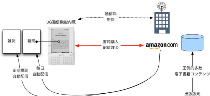
図3.12 Kindle の仕組み
