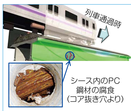
図3 列車通過時のPC桁の曲げひび割れの発生 10)
