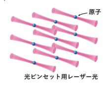
レーザー光で原子を1個ずつ捕獲し、 格子状に配置する
