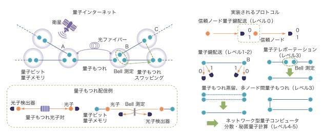
図2 量子暗号通信を含めた量子インターネットの概念図
