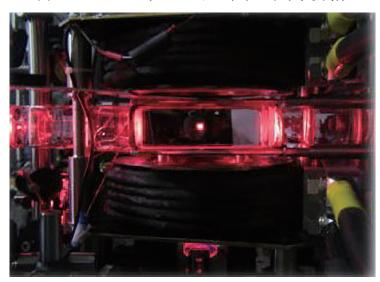
図2 ガラスセル中のリチウム (Li) の冷却原子気体
