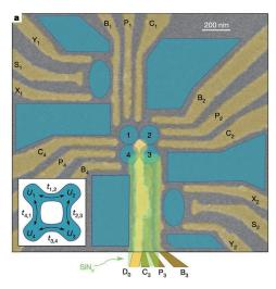
図5 半導体量子ドットデバイスの電子顕微鏡写真
