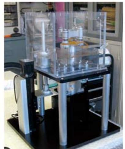
ミニマル型装置や研究装置を生産装置として機能させる、開発中のPLAD1号試作機
