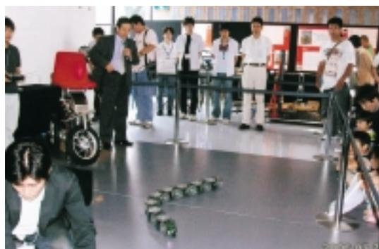
6'. 水陸両用ヘビ型ロボット；制御コンピュータ，電池などを内蔵した完全防水構造のロボット（展示は映像のみ）。（同上）
