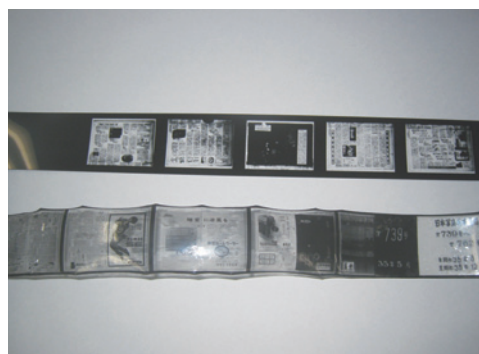
状態のよいPETベースフィルム(上) 劣化したTACベースフィルム(下)
