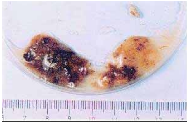
写真 4.3.8 ディスポーザー設置地区の管渠内より採取した付着物
