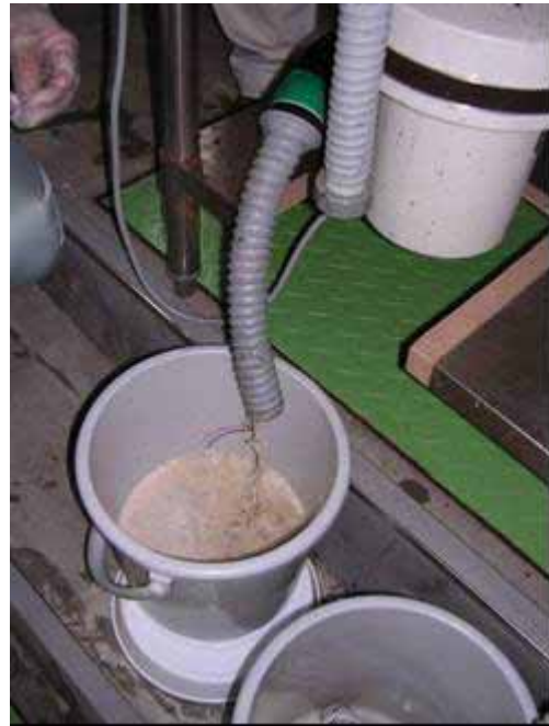
ディスポーザー排水の回収状況
