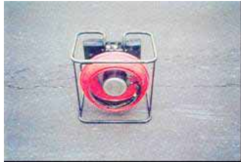
写真 3.1.1 テレビカメラ車（左）・排水管用カメラ（右）
