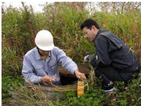
写真 4.8.1 拡散式硫化水素測定器の設置状況
