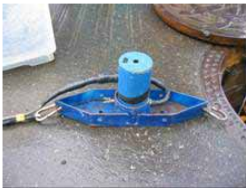
写真 4.5.1 勾配測定（水位測定器）の状況
