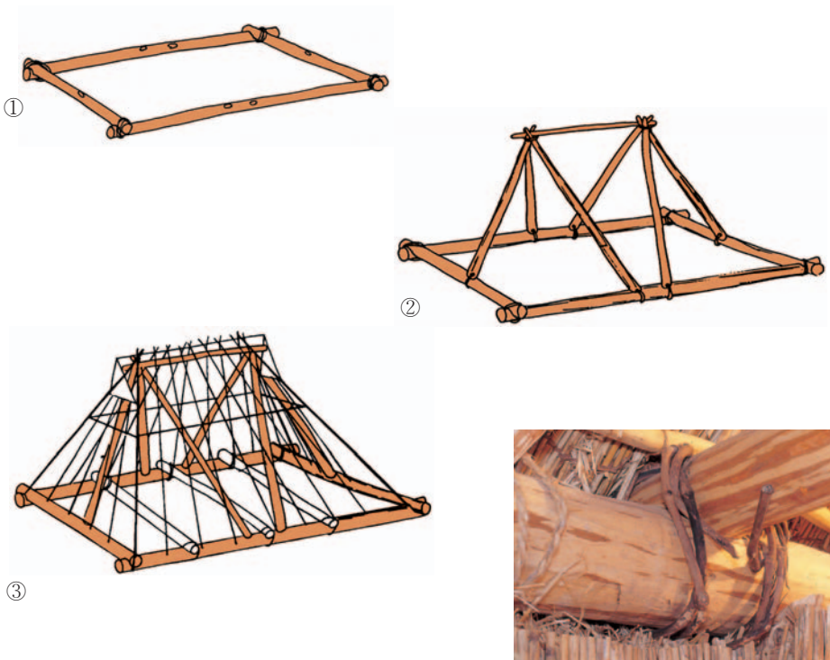
写真12 骨組みの結び
