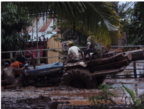
図6 雨でぬかるんだ土の上を走る高級木材の運搬車によって壊される村の道路。
