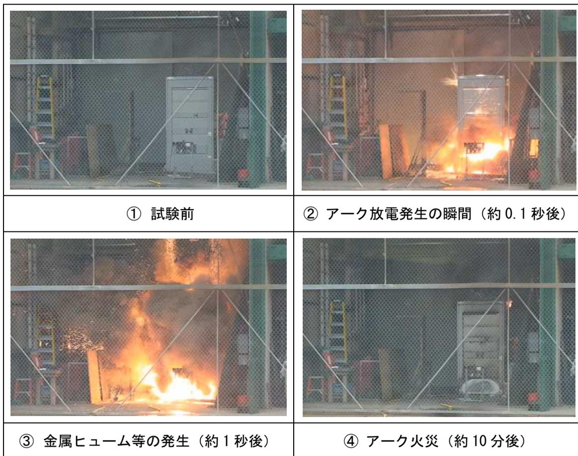
図 4. 2 配電盤の HEAF 試験
