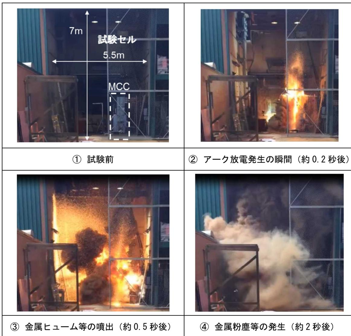
図 4. 3 モータコントロールセンタの HEAF 試験
