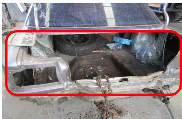
赤線部分を切断し、左写真の車両に替える
