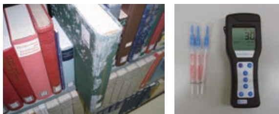
（右）ATP（アデノシン三リン酸。細菌やカビなどを含む全ての生物が持つ化学物質）の拭き取り検査の機器と検査キット。
