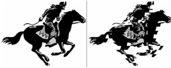
図7.5 動体を飛び越し走査で撮影
