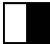
図5.8 SFR測定用階段状パターンの一例
