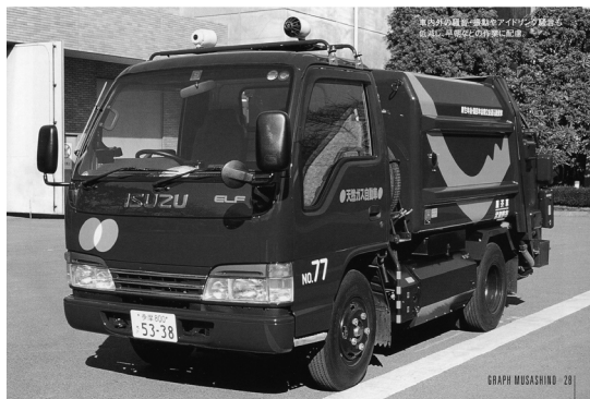
天然ガス仕様のごみ収集車、 パッカー車を平成12年9月から導入
