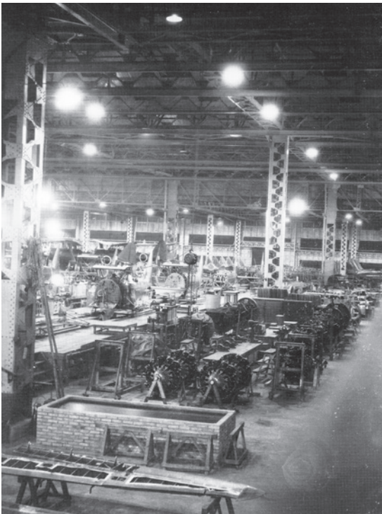
写真3-16 タクトシステム (活き活きおむら推進会議編『楠のある道から』 活き活きおむら推進会議、2003年 37頁から)
