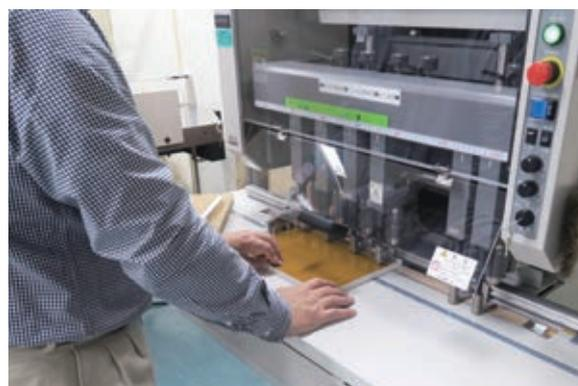
本の綴じ直しをするときに穴を開ける機械です。ドリルが垂直に下りてきて、最大6ヶ所同時に穴が開けられます。本の大きさにもよりますが、通常は3～4箇所に穴を開けて糸で綴じます。資料の形態や状態に応じて、目打ちを使って手で穴を開けることもあります。
