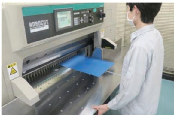
表紙に使う布、保存箱にする厚紙、和紙、各種洋紙などを断裁します。大量の紙の束も一度に切ることができます。両手で同時に断裁スイッチを押さないと、刃が作動しないように安全装置が付いています。
