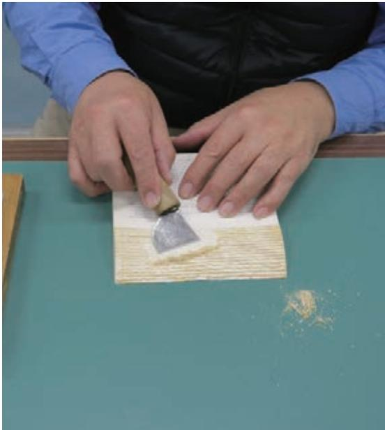
背の部分に接着剤を使った製本形体の本を製本し直すとき、背の接着剤を削り取る「バラ落とし」という作業に使用します。
