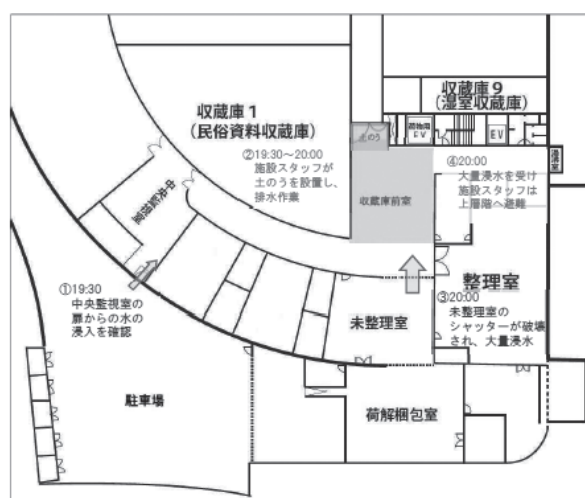
図1 市民ミュージアム施設内への浸水状況(10月12日19時30分から20時)
