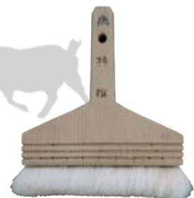
裏打ちをする際に裏打ち紙を撫でて接着させるために使う刷毛です。なぜ刷毛にも種類があります。
