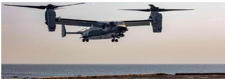
図3 転換モードでの飛行
