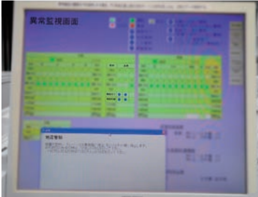
実際のエレベーター監視画面。地震管制が働いたことを知らせてくれます。
