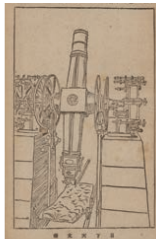
(中央) 日下博士の天文台の装置。子午環（天体の赤経・赤緯を精密に測定するための観測装置）と思われる。
