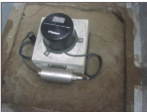
写真 震度計センサー設置環境 センサー周辺の地面に多数の亀裂を確認
