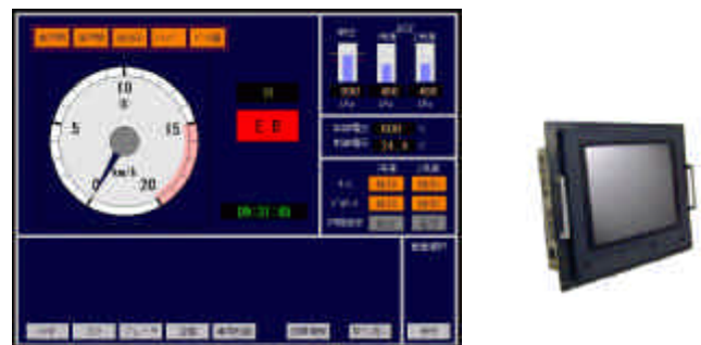
図7 モニタ表示画面と表示器外観 Fig.7 Display of monitoring system
