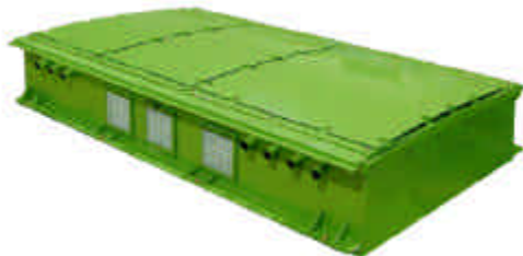
図5 車両制御装置外観 Fig.5 Main control equipment
