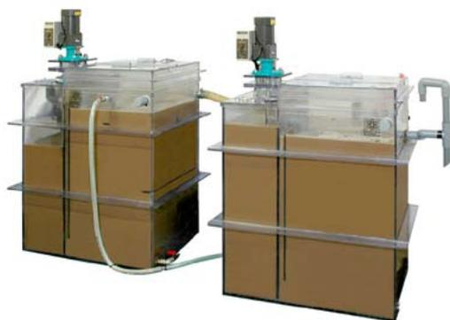
写真1 無希釈窒素処理システム試作機
