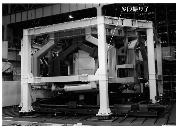
図6 ハイブリッド型HMD(吊り式) 多段振り子型を示す。多段振り子により装置の高さを低くできる。
