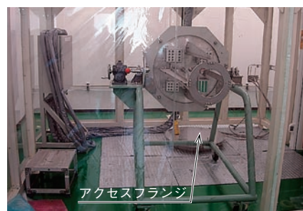
図5 クリーンブース 燃焼試験設備で使用しているクリーンブース (スラスタセッティング時に使用) の外観を示す。
