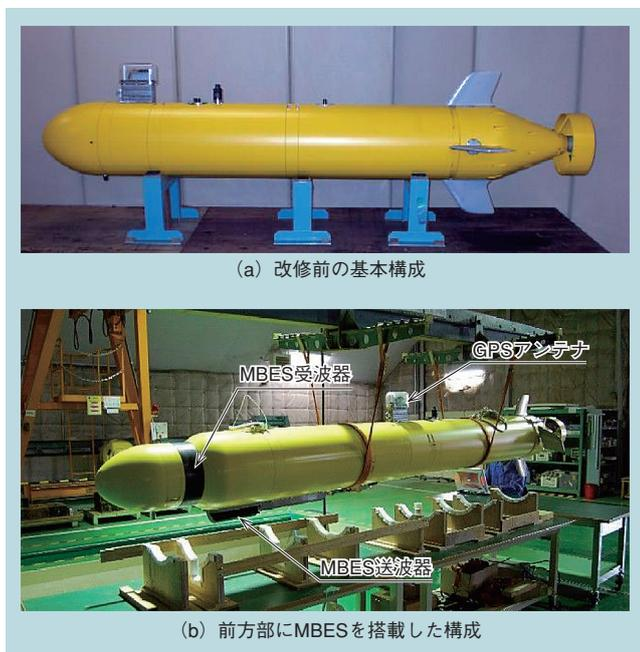
図4 UUV 実証機の概観
