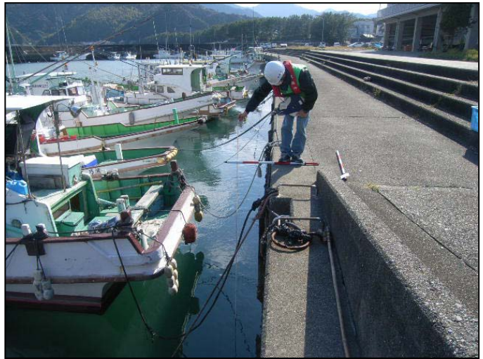
写真 15 津波の痕跡（目撃証言による最高潮位の位置を測定、図 20 の 75）
