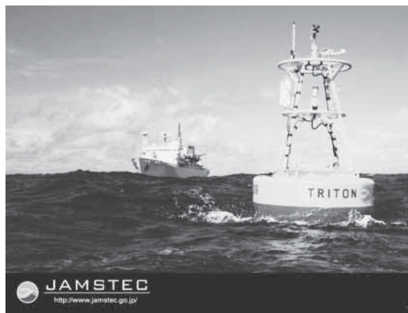
図3 （独）海洋研究開発機構が赤道付近に展開するトライトンブイ
