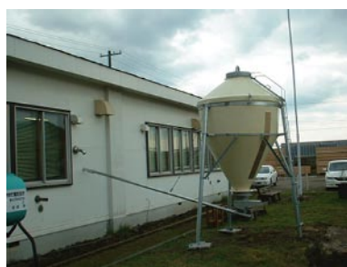
写真1 バネコンの使用例（搬送距離は2～3m）
