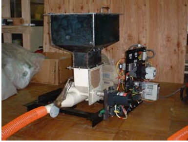
写真2 試験機 (ペレット供給・送風側)
