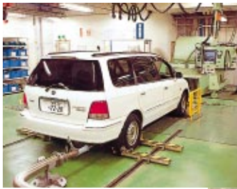
ケーヒンの核となるシステム開発の拠点が、栃木、角田(宮城)、川崎の各開発センター。シャシーダイナモでは実車レベルで性能解析を行う。
