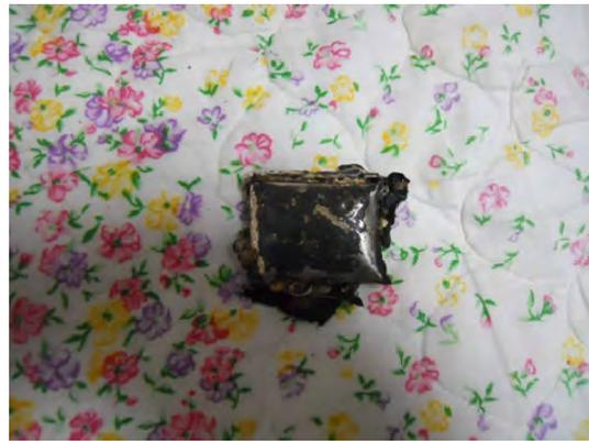
写真② 焼損状況 (電池パック)
