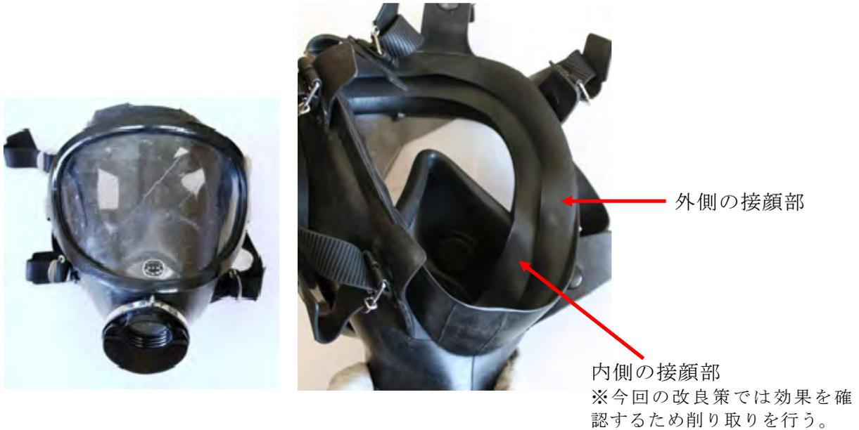
L-SV 面体の接顔部は「二重リップ構造」で、激しい活動でも気密を保持する構造となっています。
