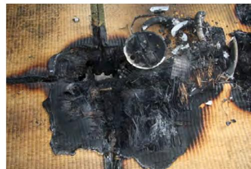
No.10 金属製の上蓋に接し燃え抜けている畳、床部分。焼け止まり部分には溶融した樹脂がへばりついている。
