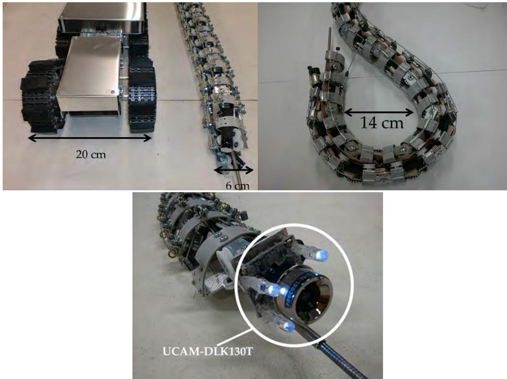
図 11 開発されたマニピュレータ
