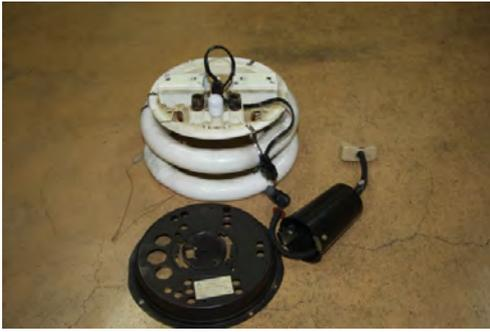
No.23 照明器具の金属製上蓋をはずした状態。金属製上蓋はグローランプと豆球を設けている部分の孔と熱を逃がすための孔が多く見られる。
