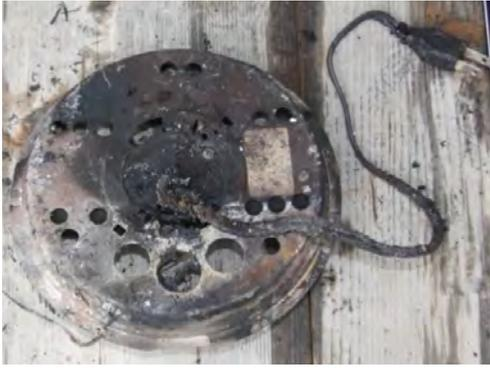
No.17 金属製上蓋の外側の焼き状況。豆球、グローランプの孔部分の焼きが強い。
