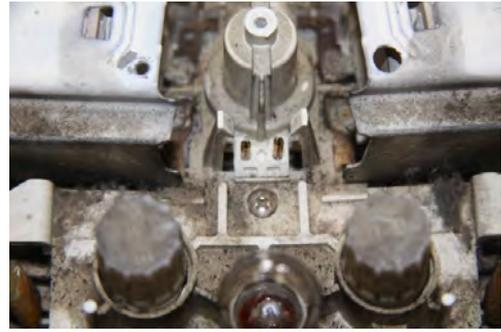
No.48 接触部の接写。中央のプラグ金具はNo.46の写真では焼きし焼失している。
