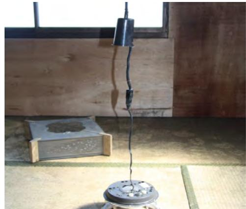
No.14 同型の蛍光灯器具、樹脂製シーリングカバーを開けて内部電源コードを伸ばしたところ。
