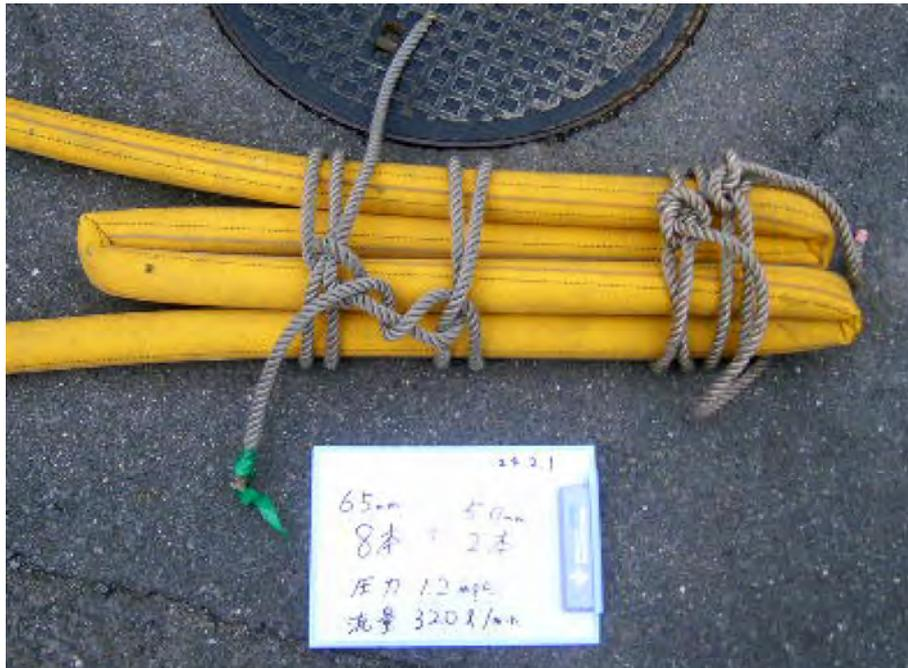
写真 5 実験 B において 50 ミリホースに 180 度曲折を 3 箇所作った様子
