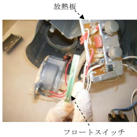
写真 6-③ 放熱板とフロートスイッチの状況
