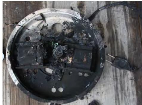
No.16 金属製の上蓋の内側の状況。外側に比較し内側の焼きが強い。
