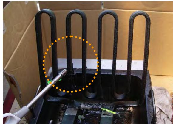
写真 9 異常過熱防止装置の作動
