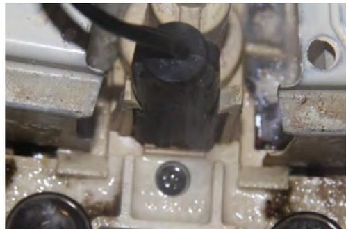
No.40 No.39 を接写、水蒸気の白煙が出ている。
