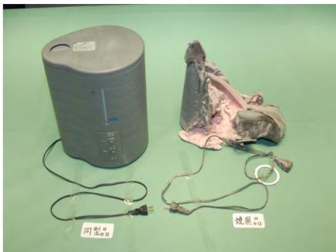
写真 7-① 焼損した加湿器と同型品の比較
