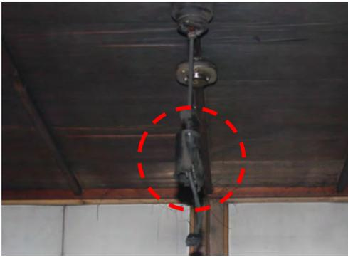
No.7 蛍光灯吊下げ部材ローゼットからコードコネクタのボディまでの状況。赤丸内は引き千切られるように焼き切れている樹脂製シーリング。
