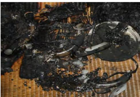
No.9 焼きし落下している蛍光灯の状況。金属製の上蓋は残存しているが樹脂製の下蓋は黒く溶融して畳にへばり付いている。
