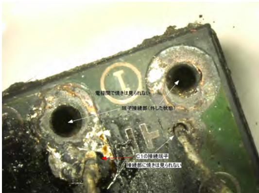
写真 13 電源基盤電極間の焼き状況
