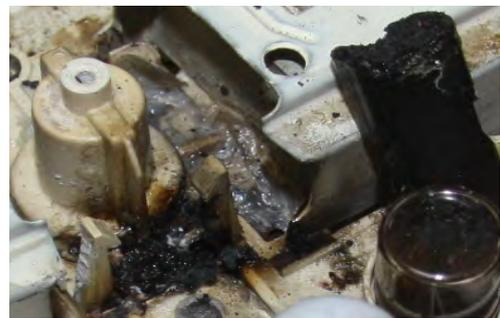
No.46 電源コードの焼き状況と接続部（白い樹脂部分）の焼き状況。プラグ、受け口双方とも金具部分は溶融し、一部焼失している。
