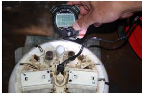
No.38 安定器は冷め、白煙はトラッキング現象の部分 (電源コード差し込み部分) のみ。
