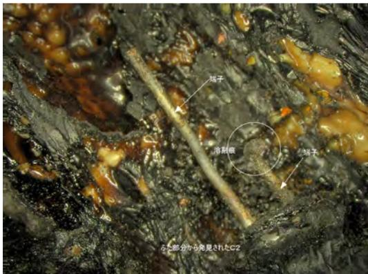
写真 21 コンデンサ素子 C2 の接続端子
