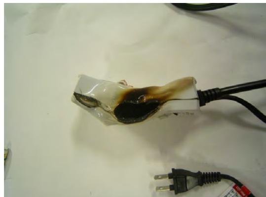
写真 6 サーモスタット側面の焼き状況
