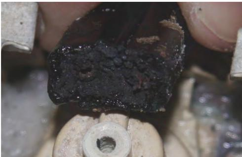
No.45 電源コードの接触面はトラッキング現象によりグラファイト化している。
