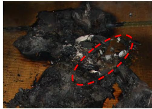
No.8 焼きし落下している蛍光灯器具。赤丸部分に樹脂製の下蓋は溶融している。
