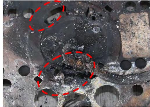
No.18 樹脂製シーリングカバーを金属製上蓋にひっかけて支持する孔が2ヶ所あるが、電源コードに近い方の孔は金属にもかかわらず焼き切れ一部焼失している。
