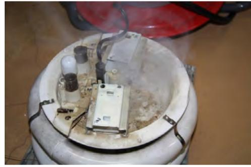
No.30 水蒸気の白煙が多量に発生。電源コード差し込み部分でのトラッキング現象は継続中。
