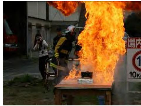
写真 22 天ぷら油火災時の注水状況
