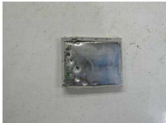
写真④ 焼損していない電池パック
