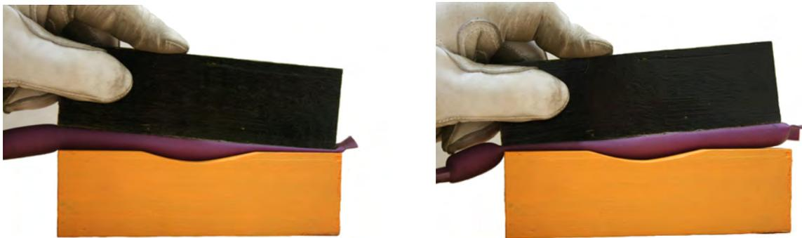
隙間は完全に埋まるものの、漏気箇所を埋めた後の余った空気の流れ場が無く、バルーンは不要に膨らみ非常に不安定である。
