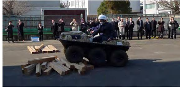
写真 2 開発中の津波浸水・ガレキ堆積域用の消防車両の実演状況
