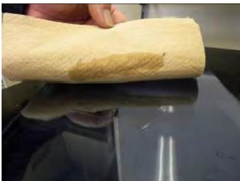
写真 9 液化した灯油の付着状況 1
