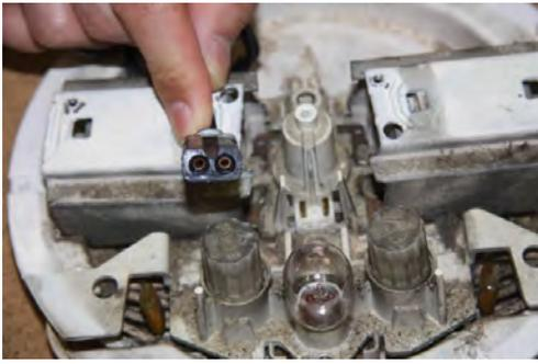
No.47 電源コードと接触部分の焼損前の状況。
