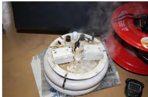
No.28 水蒸気の水煙と器具の電源コード差し込み部分にトラッキング現象が現れた。
