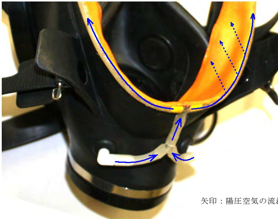
バルーンを膨らませる陽圧空気は、面体下部に取り付けたゴムホースにより、面体内からバルーンへ供給されます。
