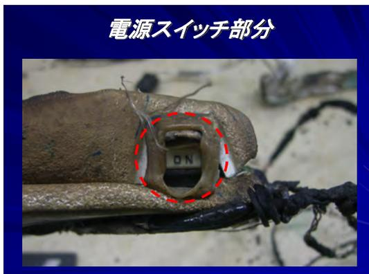
写真 6 サーモスタットの電源部分
