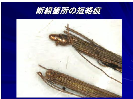
写真 10 延長コードの断線箇所
