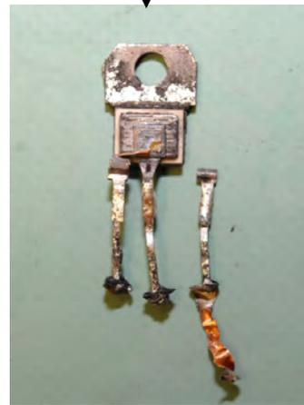
写真 11-⑬ 脱落した端子を復元
