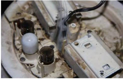
No.41 水を垂らすのを止めてから約 50 分位した頃に樹脂の燃える臭いがした。煙も白煙から灰色変わってきた。13:44 経過
