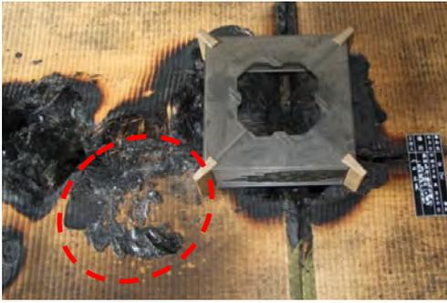
No.11 写真 No.10 の部分に吊下げられていた蛍光灯と同型のセードを置いたところほぼ同じ大きさであった。赤丸は樹脂製下蓋が熔融している部分。
