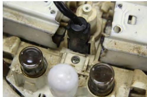
No.32 電源コード差し込み部分に極僅かな隙間があり、パチパチと音をたて火花が散っているが目視可能も写真撮影は困難。
