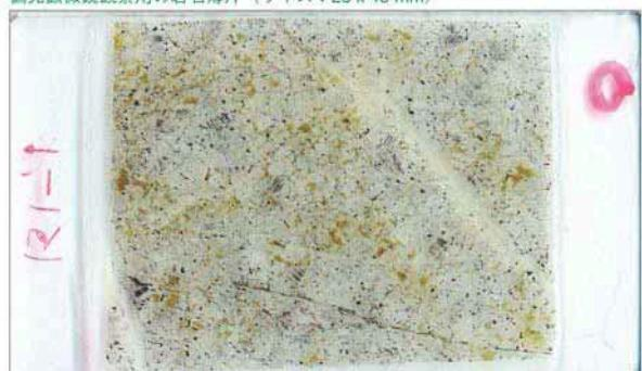
写真4 大町海山蛇紋岩(原岩タイプ:かんらん石・単斜輝石キュムレイテ)蛇紋石化したかんらん石単斜輝岩の研磨断面(上)とその薄片写真(下)。試料番号:6K#571\_R1-1。薄片写真的透明部分はキュムラス単斜輝石。その粒間を変質したかんらん石(褐色部分)が埋める。ヘテラドキュムレイテ組織を示す。
