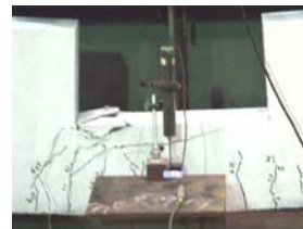
写真－７ 試験体RC 破壊状況
