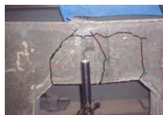
写真－６ 試験体HT 破壊状況
