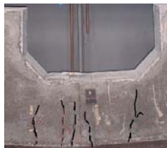
写真－５ 試験体HC 破壊状況
