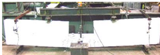
写真－７ 試験体RC 破壊状況
