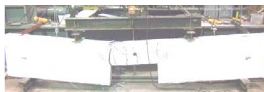
写真－８ 試験体RT 破壊状況
