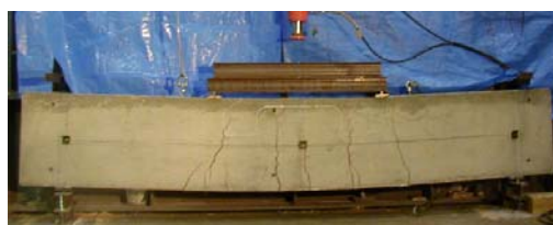
写真－３ 試験体S 破壊状況
