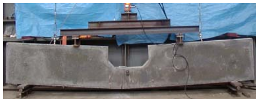
写真－５ 試験体HC 破壊状況
