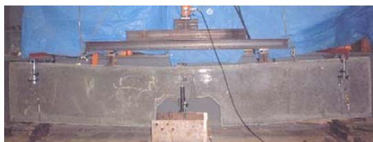
写真－６ 試験体HT 破壊状況
