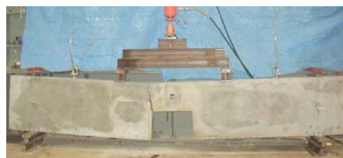
写真－３ 試験体S 破壊状況
